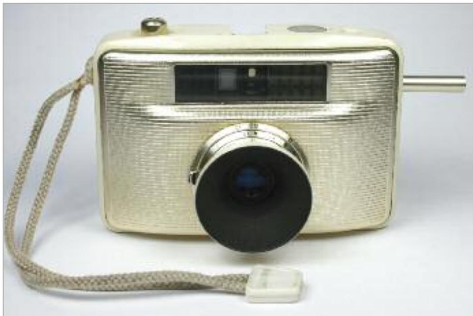
Die Penti II. Im Gegensatz zur Penti I besitzt sie einen Selenbelichtungsmesser und ist das am weitesten entwickelte Penti-Modell. Gut zu erkennen die ausgefahrene Transportstange. Die Kamera besitzt einen weißen Rahmen und eine weißlackierte Sonnenblende.
