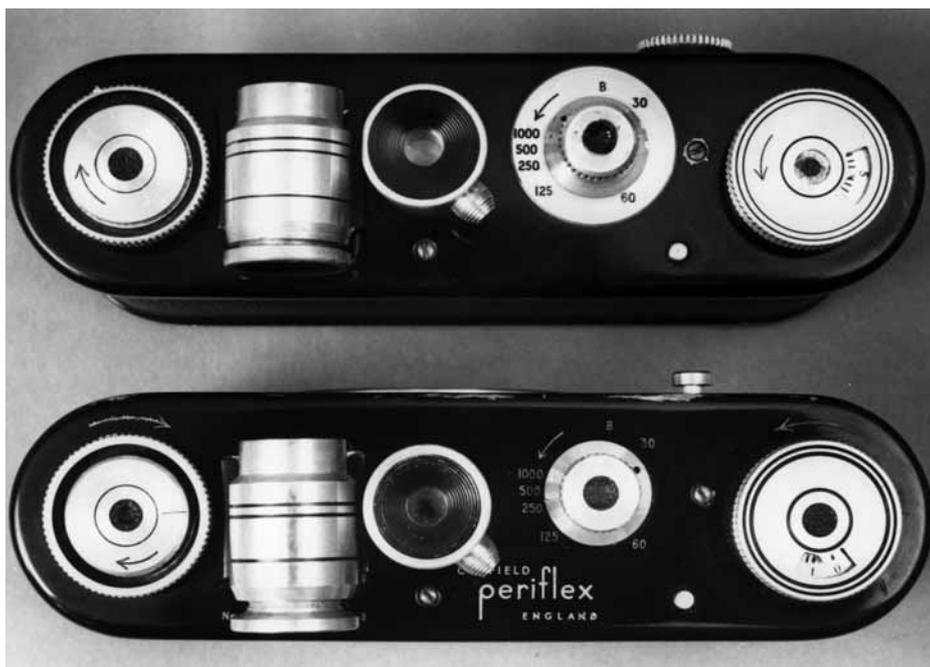
Die Deckkappen der Periflex Variante II (unten) und Variante III (oben) im Vergleich. Der Unterschied liegt in der Gravur sowie dem später hinzugekommenen Aluminiumring um den Zeitknopf. Foto: J. E. Lewis
