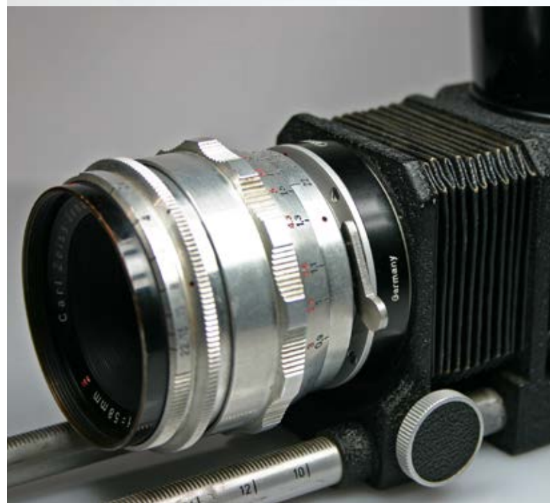
Das Exaktaobjektiv Biotar wurde mit Hilfe des Novoflex Adapters LEIEX an das Balgengerät NOBAL adaptiert, welches wiederum mit dem Spiegelkasten NOPRI an die Leica If angeschlossen wurde.
