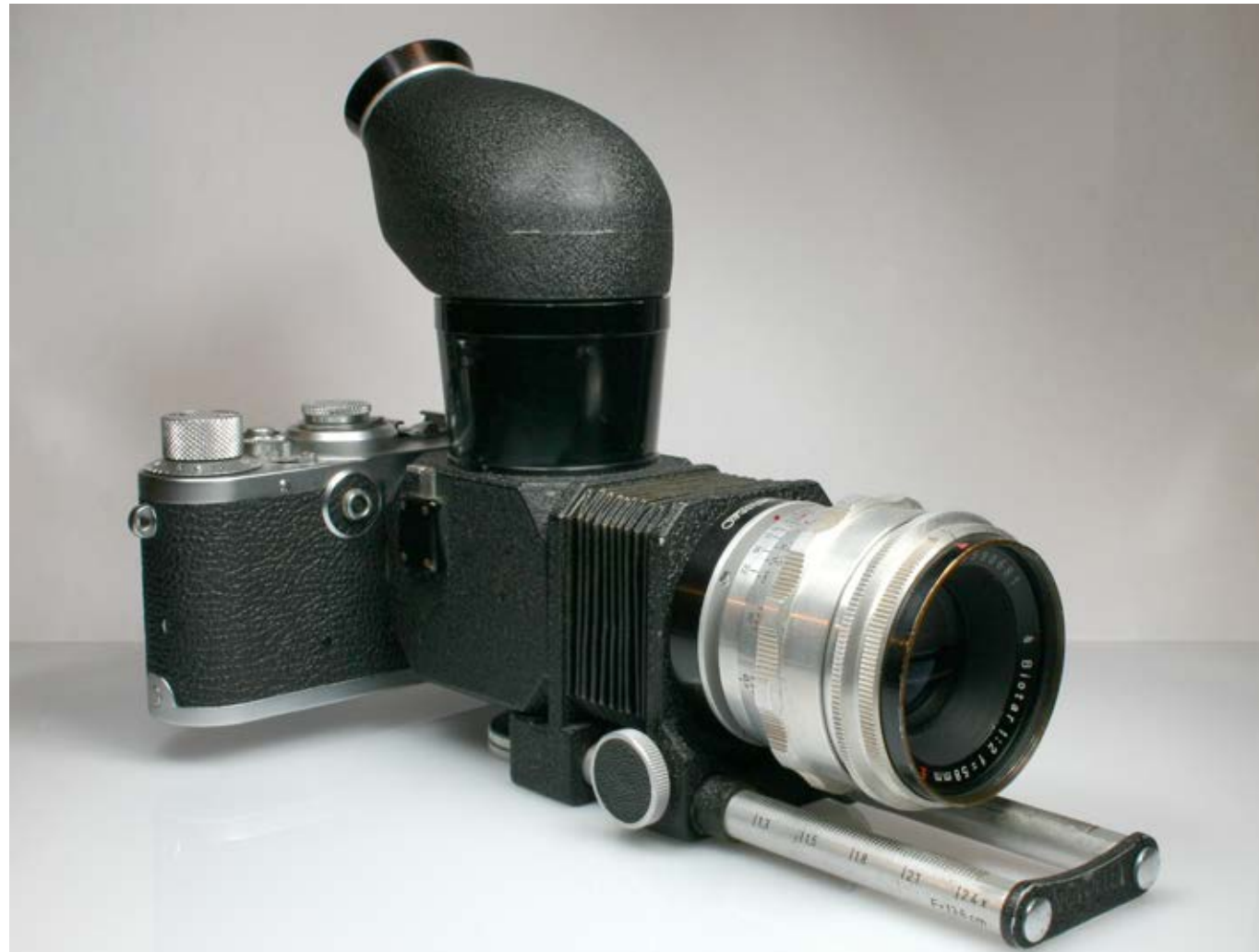
Das Exaktaobjektiv Biotar wurde mit Hilfe des Novoflex Adapters LEIEX an das Balgengerät NOBAL adaptiert, welches wiederum mit dem Spiegelkasten NOPRI an die Leica If angeschlossen wurde.
